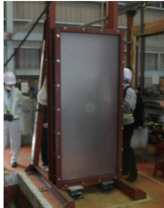
落下高さ: 450mm10回 破損: 無 加撃面側
